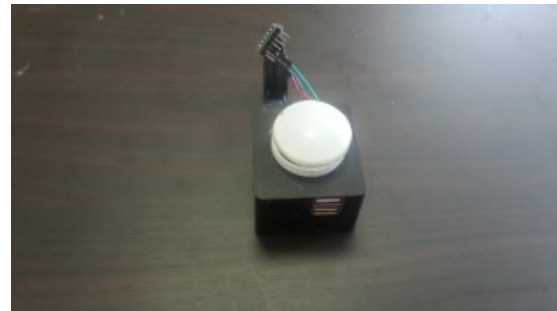
音声認識による照明カラー制御モジュール (サーバー機構も内蔵)
